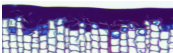
Figure 3: Découpe microtome transversale illustrant la pénétration du revêtement.
