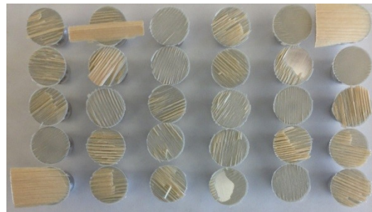
Figure 4: Dessous des pions après les tests de traction pour le traitement à l'azote
